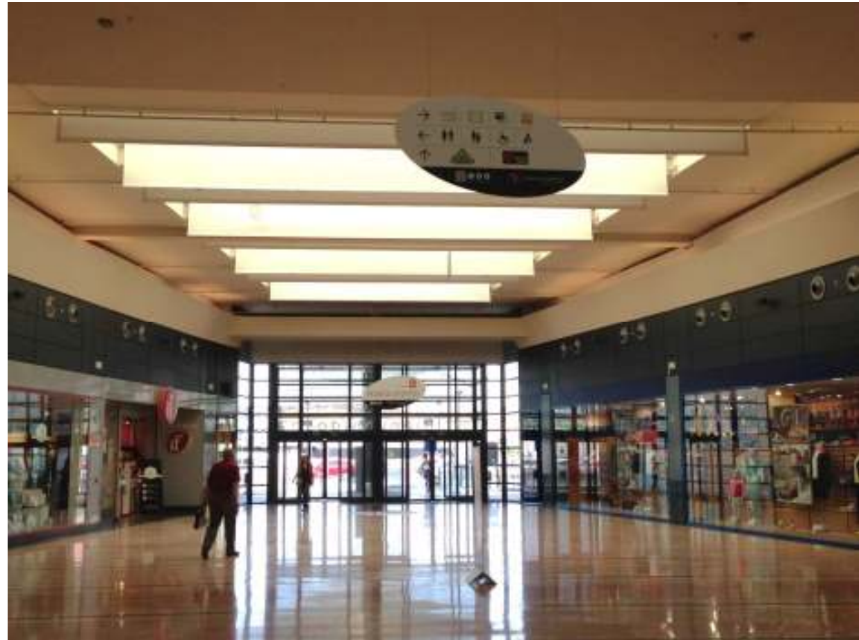
Actuaciones: Colocación de pladur en zonas horizontales de techo para ocultar estructura,, cambio de color en el bandó de tiendas, mejora de la iluminación, nueva señaletica y vegetalización.
